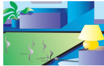
Nevedte kabely pod kobercem
