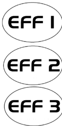
Figura 8 – Etichette relative alle 3 classi di efficienza energetica dei motori BT rientranti nell'accordo tra CEMEP e Commissione Europea DGXVII
